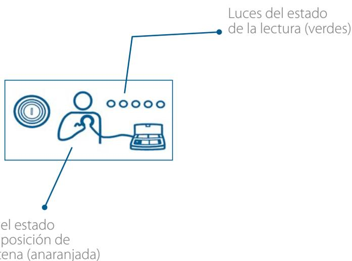
Todas las “luces del estado de la lectura” parpadearán de forma sucesiva comenzando por el extremo izquierdo de la fila, y después permanecerán encendidas. Durante este tiempo el Monitor esta leyendo y almacenando la información del dispositivo cardiaco implantado. Cuando todas las “luces del estado de lectura” estén de color verde dejarán de parpadear y se apagarán, oirá dos tonos indicando que la lectura ha finalizado. Ya puede guardar la antena en su compartimento.
