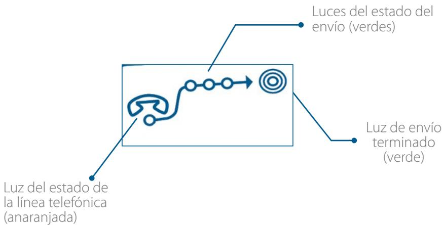
En el panel de visualización las tres “luces del estado del envío” de color verde, situadas junto al dibujo del teléfono, parpadearán de forma repetida de izquierda a derecha. Mientras se envía la información es posible que oiga tonos y pausas al principio de la transmisión de los datos. Cuando la “luz de envío terminado”, de color verde, se encienda y oiga dos tonos el proceso habrá finalizado.
